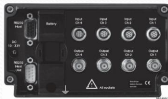
4-канален усилвател на слаби хидроакустични сигнали (от хидрофони) "Brüel&Kjær" модел 2692-A "NEXUS"
