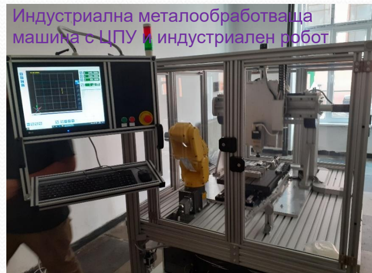
Коллаборативен робот и обучаваща станция с индустриален манипулатор
