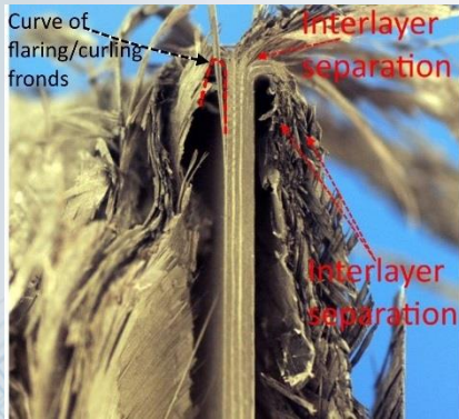
Разрушение на композитна тръба с разположени под ъгъл карбонови влакна под действие на удар
