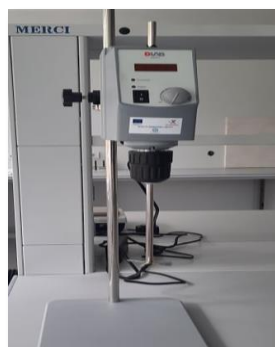
Механична бъркалка: обем до 20л, обороти до 2 200rpm
