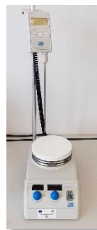
Магнитна бъркалка: до 370°C/20л/1500rpm
