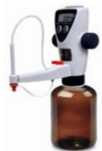
Дозатор за пълнене с електролит 50мл.
