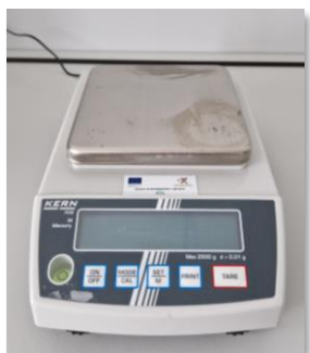
Техническа везна: до 2.5 kg, точност 0.01g
