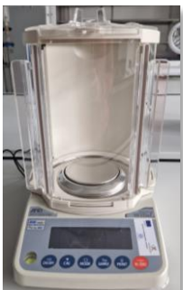
Аналитична везна: до 200g, точност 0.0001g
