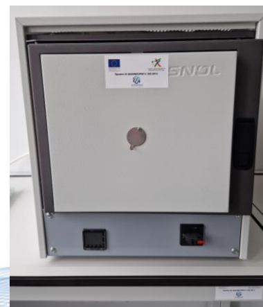
Тръбна пещ (с контролирана газова атмосфера): максимална температура: 1250°C, полезен обем 0.77 Л, максимално време за загряване: 50 мин., система за подаване и контролиране на газов поток.
