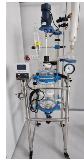
Реактор: стъклен реактор с двойно степенен съд, обем на реакционния съд 10 л, обхват на работната температура: от -80 °C до 200 °C, обхват на разбъркване от 0 до 680 rpm.
